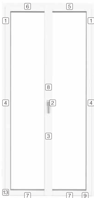
6 incontro superiore / laterale per nottolino a fungo regolabile
